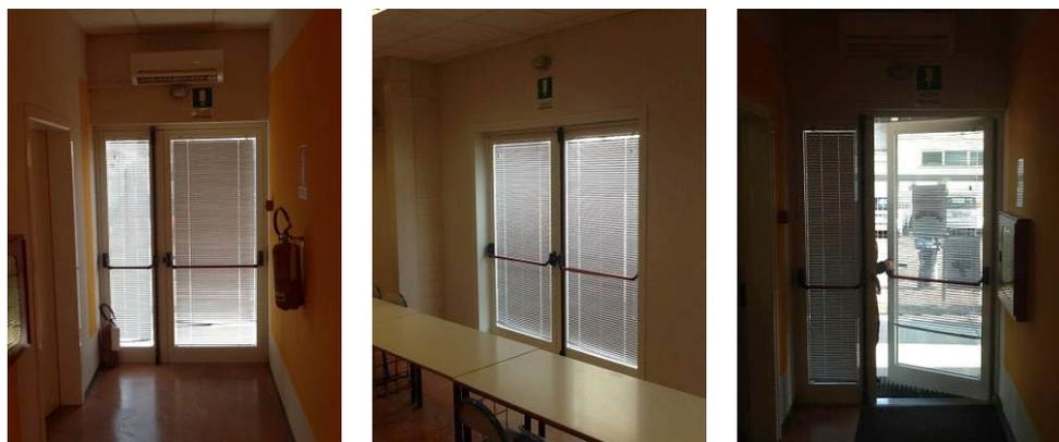
Sia le vie di fuga che le uscite di emergenza sono segnalate chiaramente con apposita segnaletica luminosa posizionata a bandiera lungo i corridoi e sopra le uscite di emergenza. Hanno una larghezza minima di 80 cm ed una altezza da terra minima di 200 cm. Sono raggiungibili con una distanza non superiore a quanto previsto dalla norme di prevenzione incendi per le scuole e sono dotate di sistema di facile apertura a spinta nel verso dell'esodo.
